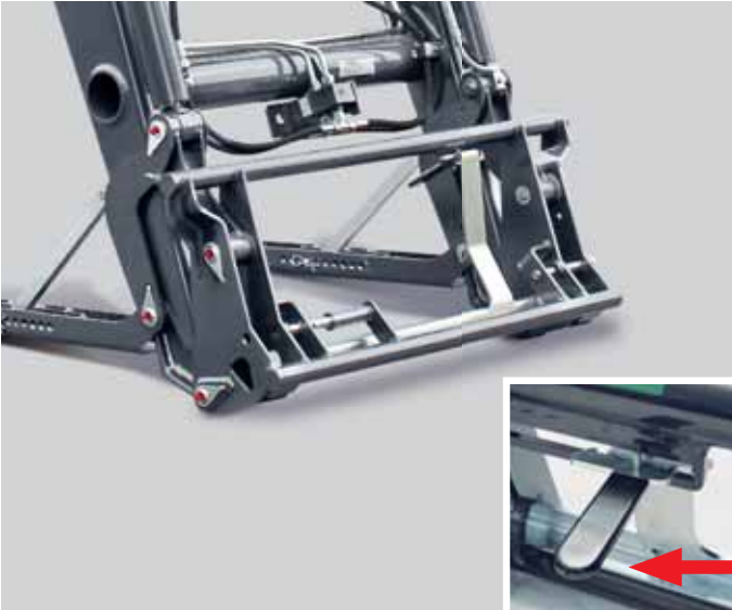
Euro-Schnellwechselrahmen mit zentraler Verriegelung (wahlweise mit Skid Steer).
