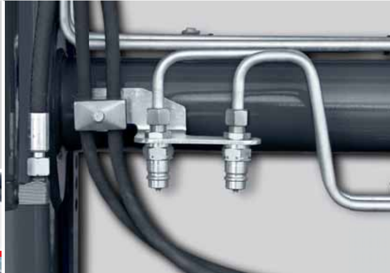
Dritter Steuerkreis zur Bedienung hydraulischer Werkzeuge z. B. mit Greiffunktion (auf Wunsch nachrüstbar).
