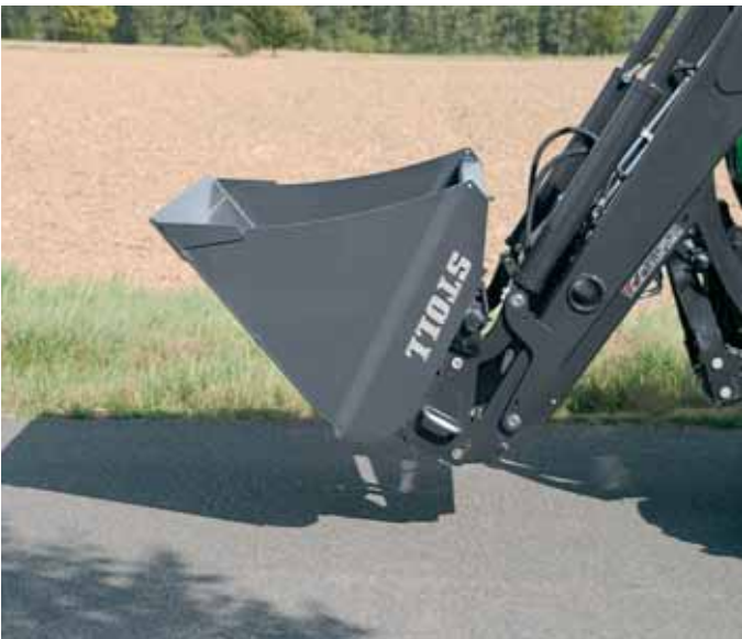
Hervorragende Ankippwinkel: ECO 650/750: 43°. ECO 850/950: 46°.
